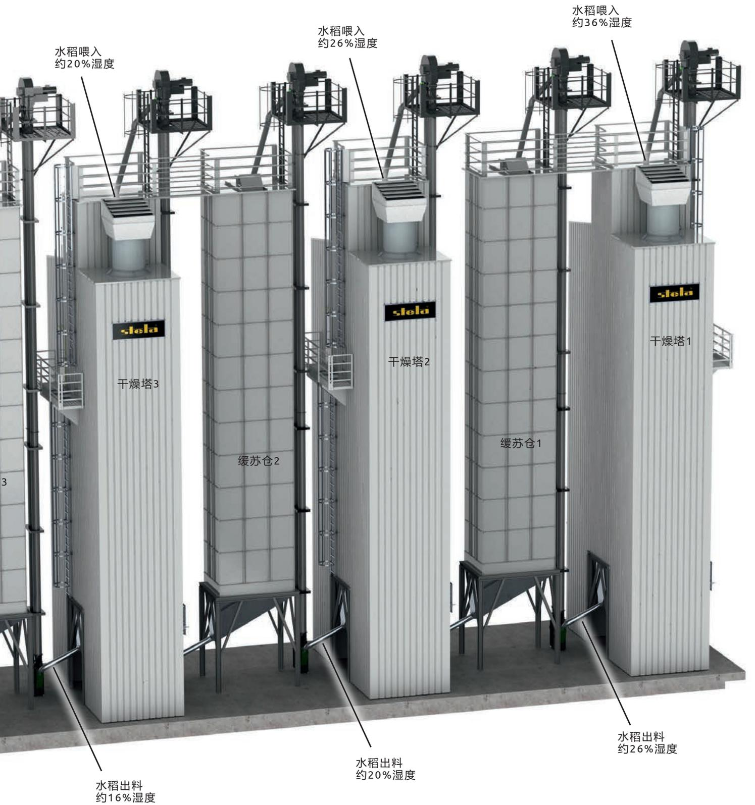
移动循环批次式干燥机MUF型通过广口喂料斗和重型提升机喂料。热风仓(1)和干燥机的外壳之间的空隙被待干燥谷物(2)完全填充。启动干燥机后，所有电机例如提升机(循环系统)，径流风机和燃烧器按照设定顺序依次启动。通过加热风机的热风被强排入内部热风仓(1)，并流经干燥仓(2)的待干燥谷物。内置减压双坡顶风管(4)确保整体物料受力均匀分布。卸粮装置(5)间断性收集干燥谷物后通过提升机(6)输送谷物到干燥仓上部。在上面的不通风区域作为物料暂存和缓苏区("缓苏过程")。MUF110型除了干燥仓上部的暂存仓之外还有缓苏仓，干燥谷物可在此无通风暂存缓苏。谷物在干燥机底部通过卸粮辊(5)卸粮并向上提升。MUF110型的卸粮辊按照长度不同分段，由计算机在不同的时间段内控制运转，确保谷物均匀混合并分配到不同的区域。
