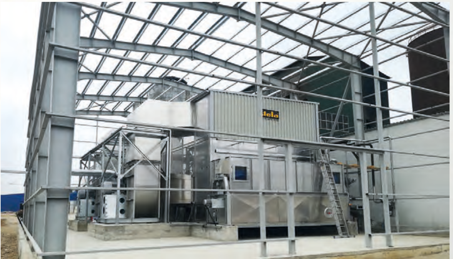
项目地: Vrancart S.A., 罗马尼亚 | 型号: BTU 1/6200-15-2/2 | 安装年份: 2018 干燥物料: 造纸污泥 | 蒸发量: 2.35吨/小时
