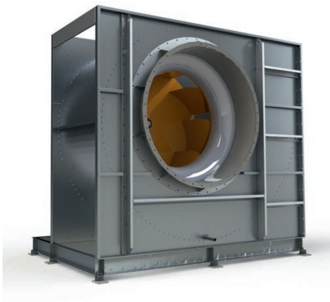
径流风机 高达160,000立方米/小时体积风量 静压差高达3,000帕
