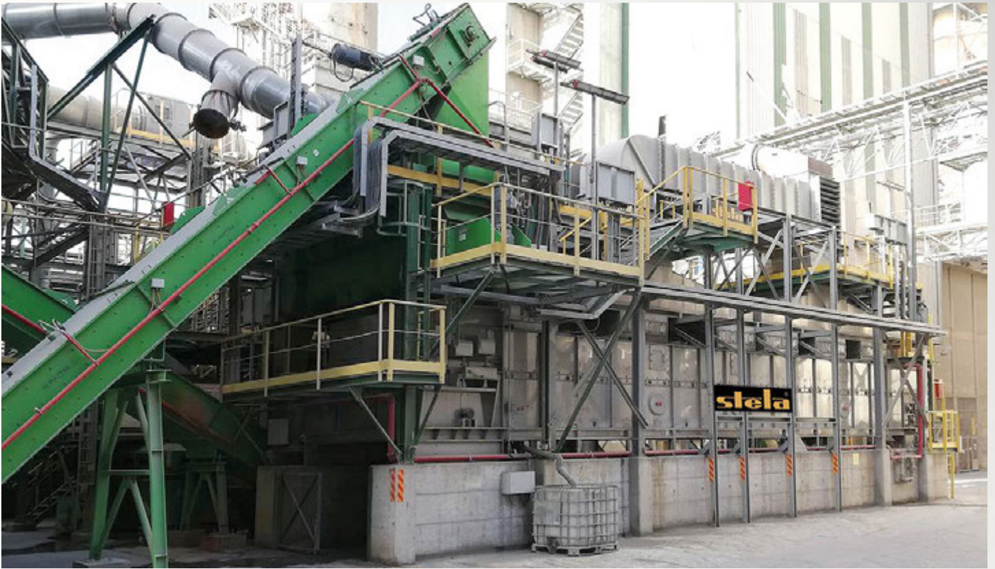
项目地：Nesher Israel 水泥, 以色列 | 型号：BTLU 1/3000-16-2/1 | 安装年份：2018 干燥物料：RDF垃圾燃料 | 蒸发量：最大1.1吨/小时
