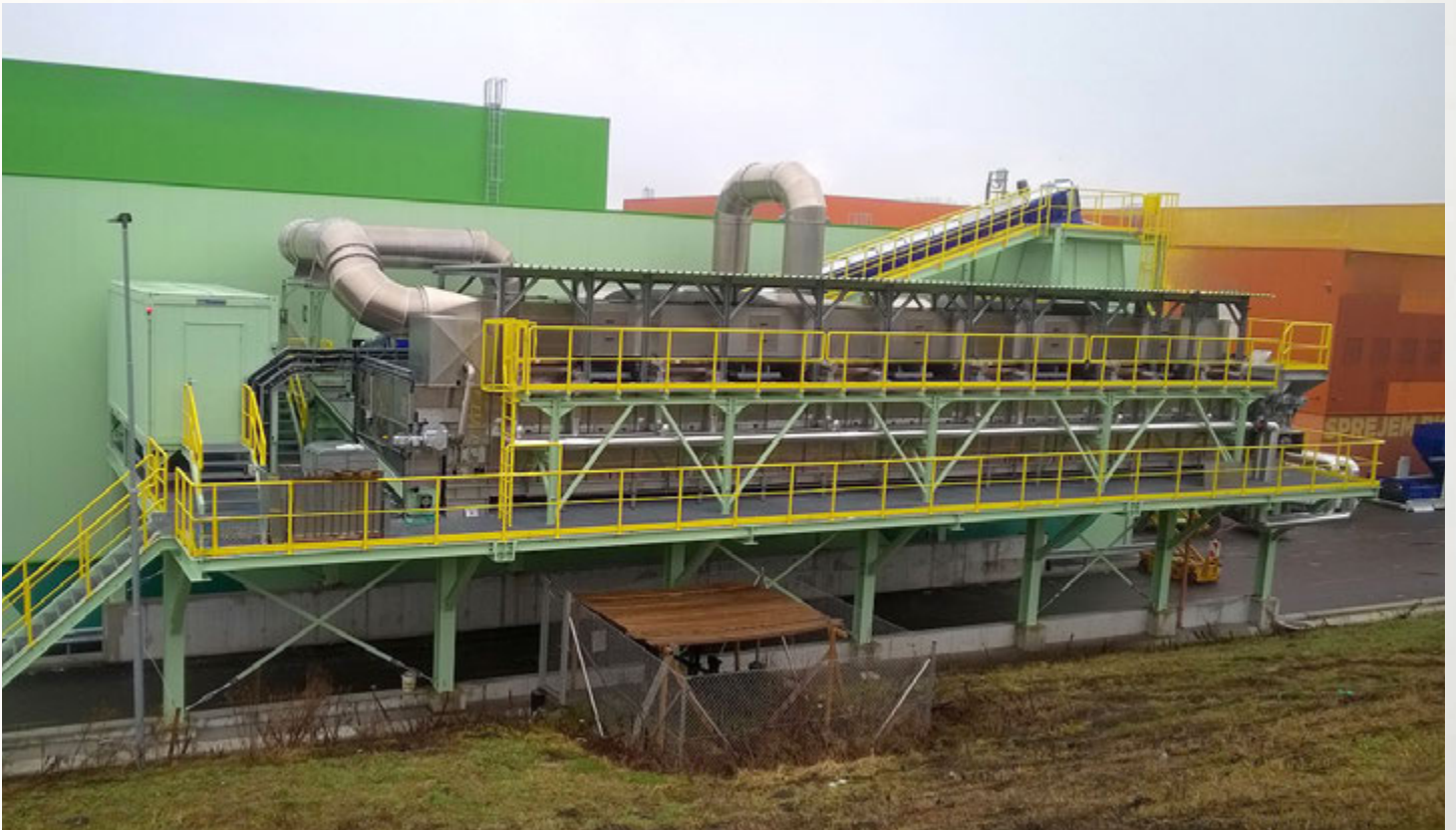
项目地：Strabag, 斯洛文尼亚 | 型号：BTLU 1/3000-54-6/5 | 安装年份：2018 干燥物料：MSW城市固废 | 出料能力：约7.0吨/小时 | 降水区间：28% - 15%湿度
