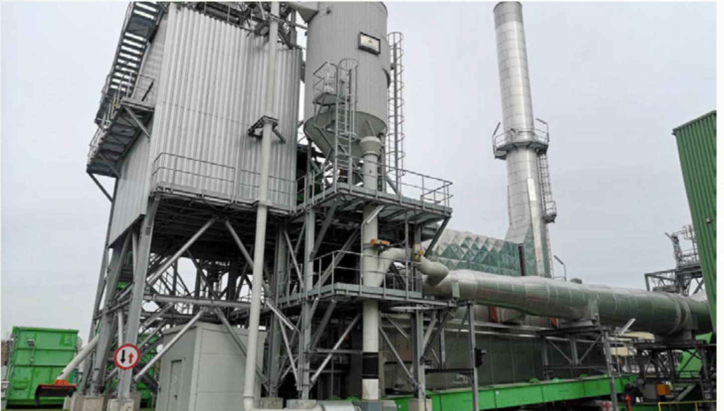
项目地：Gorazdze Cement, 波兰 | 型号：BT 1/6200-16.5 | 安装年份：2017 干燥物料：RDF垃圾燃料和MSW城市固废 | 出料能力：约20.0吨/小时 | 降水区间：35% - 20%湿度
