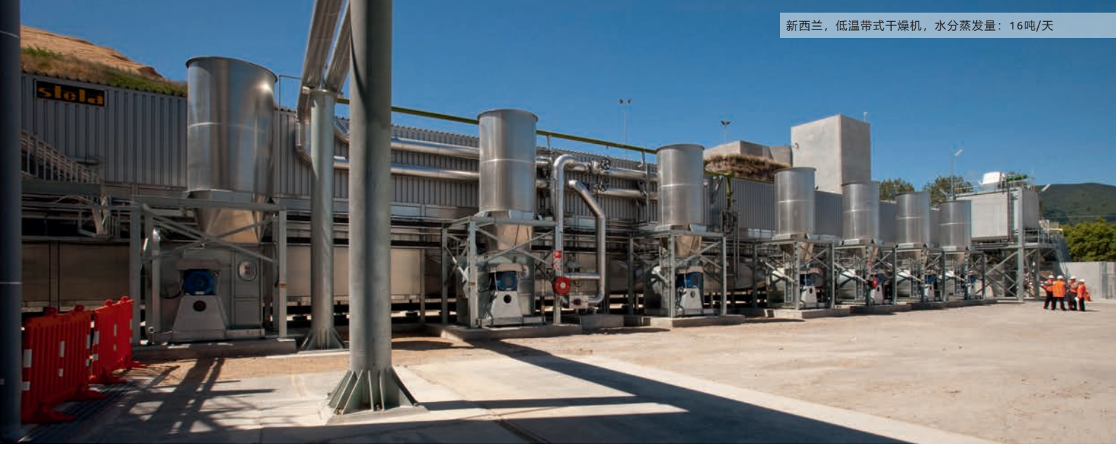
德国，低温带式干燥机，水分蒸发量：4.7吨/天
